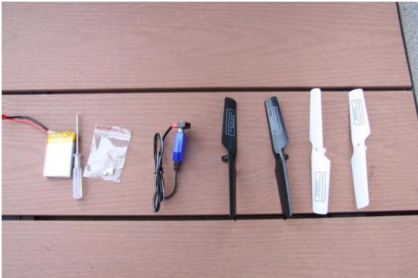
Quadcopter батареи: 3.7V 500mAh Li батарея с модулем защиты (в комплекте)
